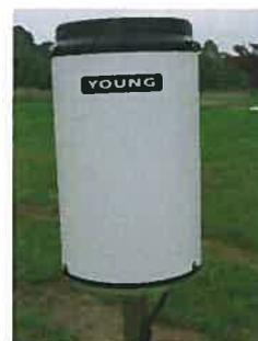
*El pluviómetro se comporta como un interruptor. Para evitar falsas lecturas se recomienda su conexión al equipo contador de pulsos en un contacto libre de potencial*
